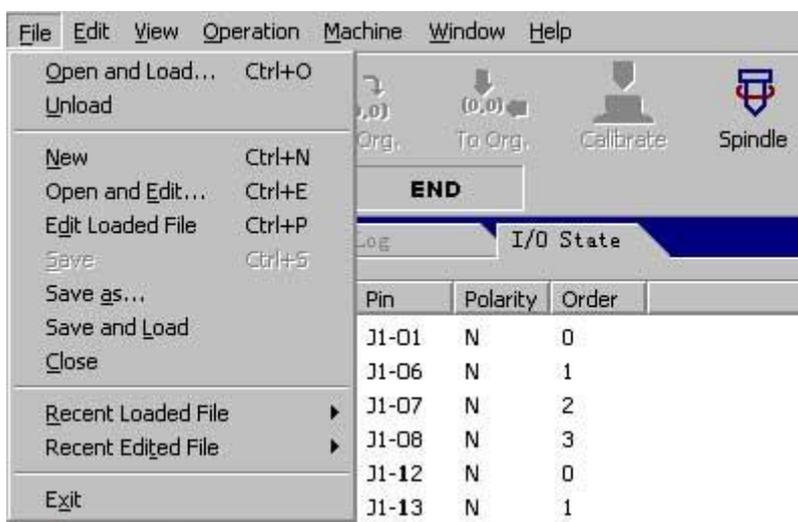
Первые два пункта меню используются для загрузки и выгрузки файлов обработки. Эти
