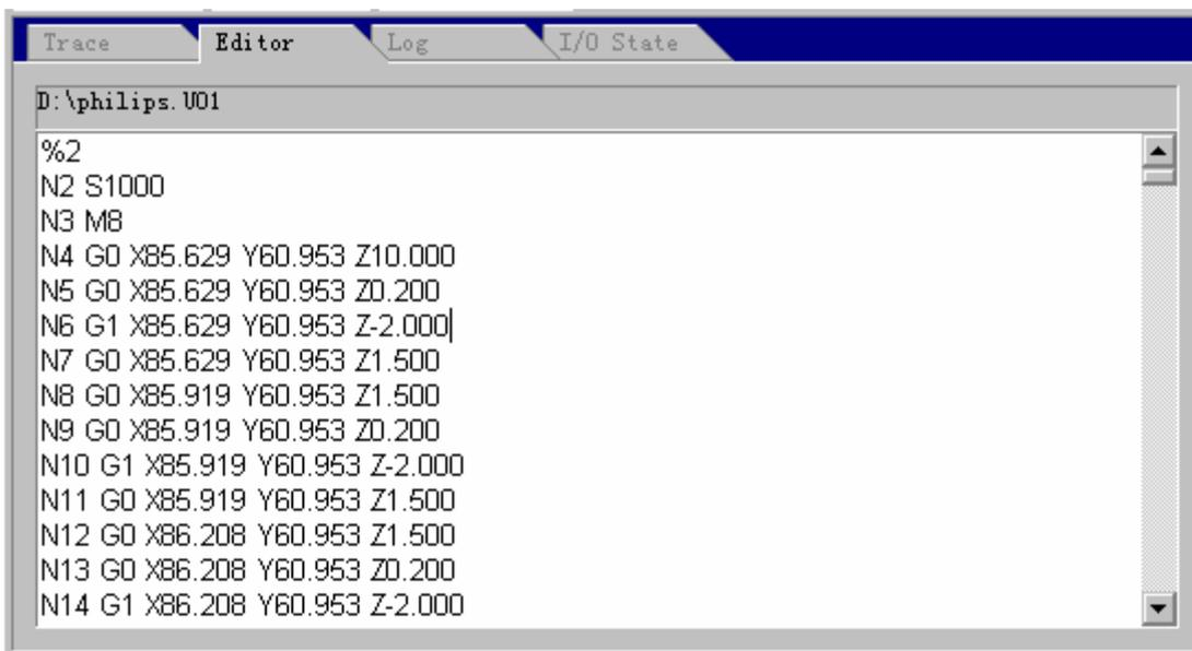
Используемый редактор превосходит по возможностям стандартный Блокнот Windows. Теоретически он позволяет работать с программами размером более 1000 Мбайт и обеспечивает возможность редактирования любых сложных процедур.
