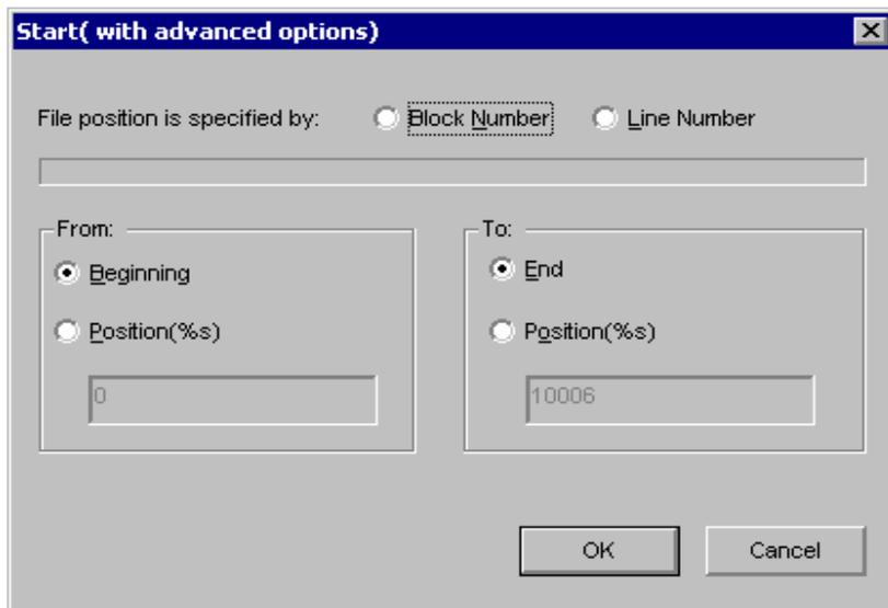
В этом окне оператор должен ввести номера начальной и конечной секций выполняемого участка программы обработки и щелкнуть мышью на кнопке ОК. После этого станок начинает выполнение указанных секций программы.
